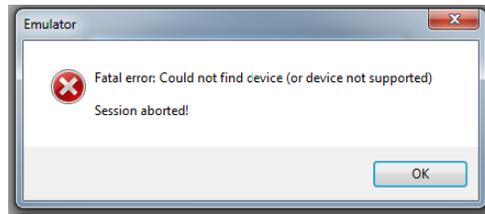
図 61. ハードウェアと、IAR で選択したデバイスとの不整合によるエラー
