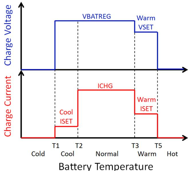
**Figure 3. BQ25619 Adjustable JEITA Temperature Profile**
