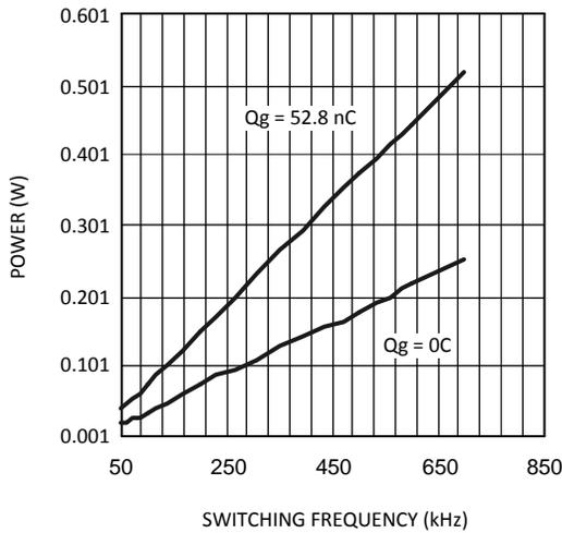
**Figure 3. Internal-Diode Power Dissipation**
