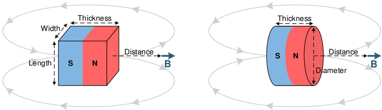
図 8-2. 長方形ブロック型と円柱型の磁石
