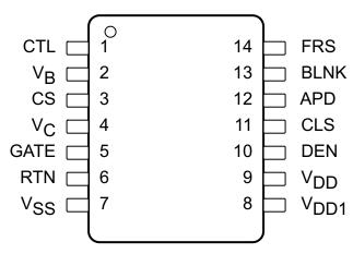
図 6-1. PW Package 14-Pin TSSOP Top View
