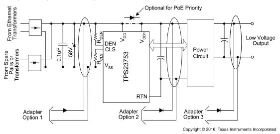
図 8-9. ORing Configurations
