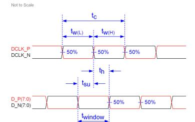
図 6-6. SubLVDS Switching Parameters
