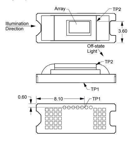
図 7-1. DMD Thermal Test Points
