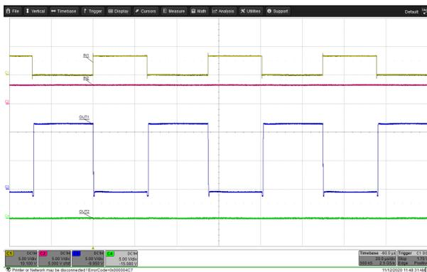
A. チャンネル 1 = IN1    チャンネル 2 = IN2    チャンネル 3 = OUT1
