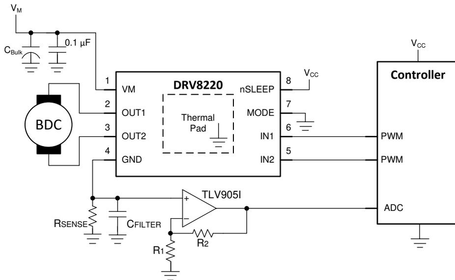
図 9-24. 電流センス・アンプの例
