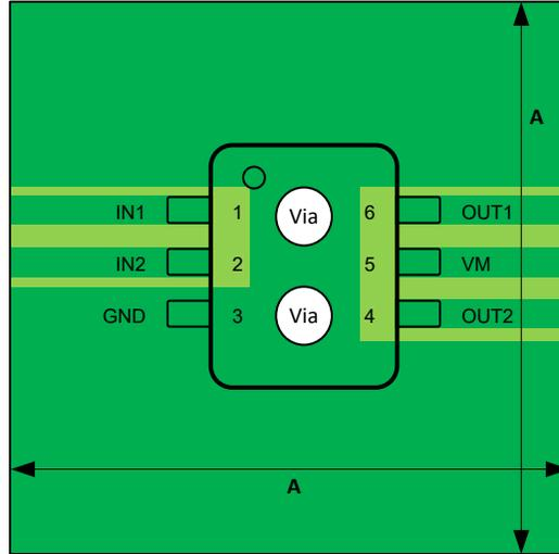
図 9-27. SOT PCB モデルの上層
