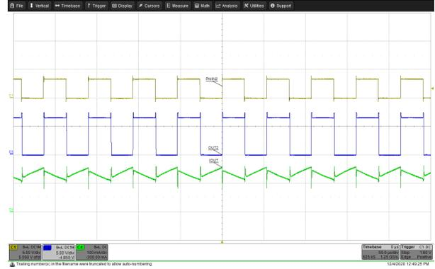
A. チャンネル 1 = IN2 チャンネル 2 =  $V_{OUT2}$  チャンネル 4 = モーター
