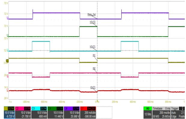
A. チャンネル 1 = IN1 チャンネル 2 = IN2 チャンネル 3 = V<sub>OUT1</sub>
