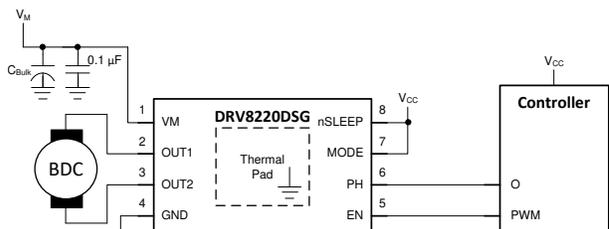
図 9-4. PH/EN インターフェイスのモーター駆動アプリケーション
