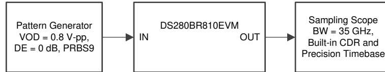
图 11. Minimal Rx/Tx Channel Test Setup
