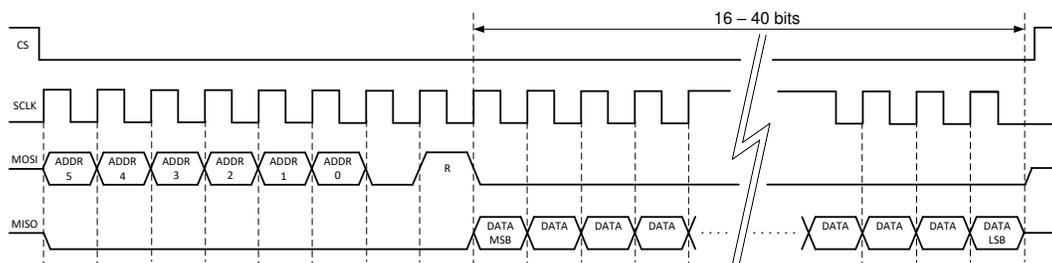
図 7-7. SPI 読み取りフレーム
