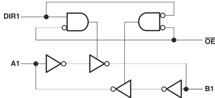
图 9-1. Logic Diagram (Positive Logic)
