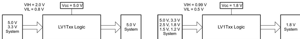
図 8-2. LVxT の昇圧および降圧変換の例
