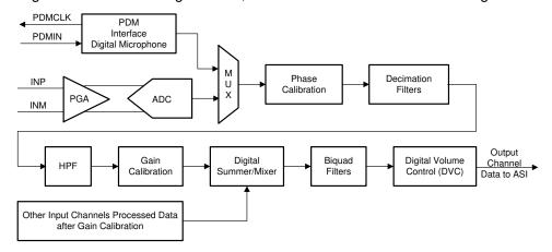
図 8-16. Signal-Chain Processing Flowchart
