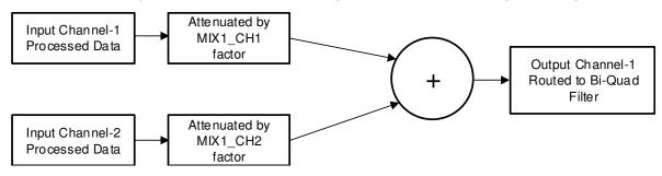
図 8-18. Programmable Digital Mixer Block Diagram
