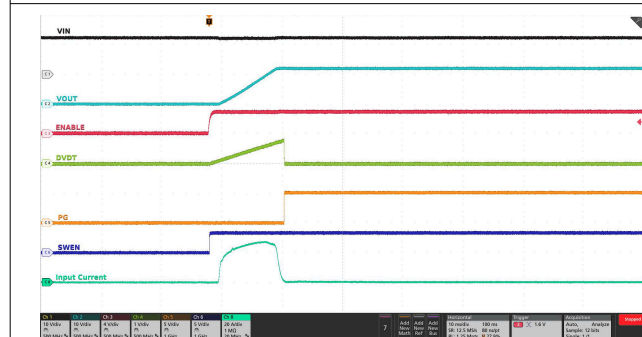
図 6-25. クイック出力放電 (QOD) を使用し、EN/UVLO ピンを使用したパワー ダウン制御
