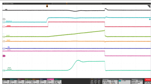
図 8-8. パワーアップ時の短絡: V_{IN} = 12\text{V} 、EN/UVLO は 0V から 3V に昇圧、 R_{REF} = 40.2\text{k}\Omega 、各デバイスの R_{ILIM} = 442\Omega 、OUT は GND に短絡
