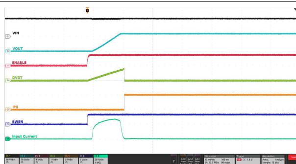
図 6-20. 入力電源を使用した電源制御立ち上げ
