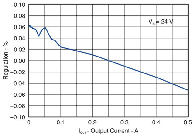
図 52. レギュレーション 対 負荷電流
