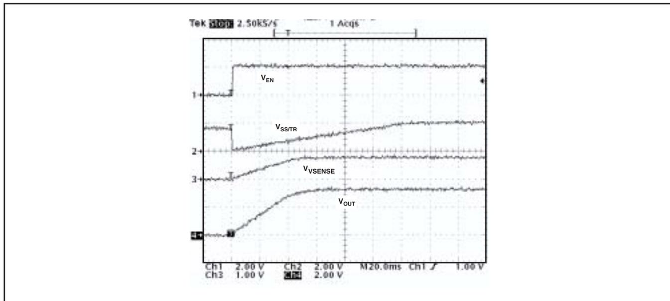
図 29. 起動時のSS/TRピンの動作
