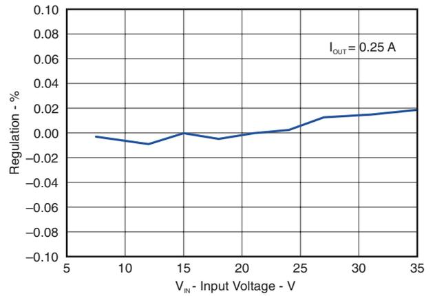
図 53. レギュレーション 対 入力電圧
