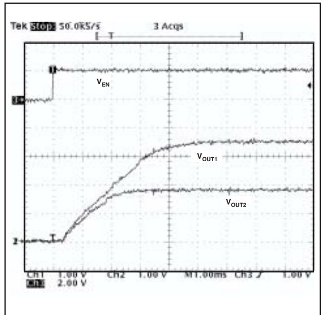
図 36.  $V_{out1}$ が $V_{out2}$ に先行するレシオメトリックなスタートアップ
