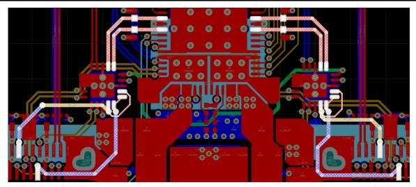
図 11-14. Complete CC Routing
