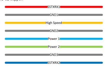
図 11-3. 8 Layer Board Stack Up
