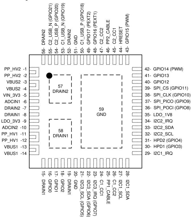
図 5-1. RSH Package 56-Pin QFN Top View
