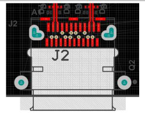
図 11-7. Type-C Connector SSTXRX Top Layer
