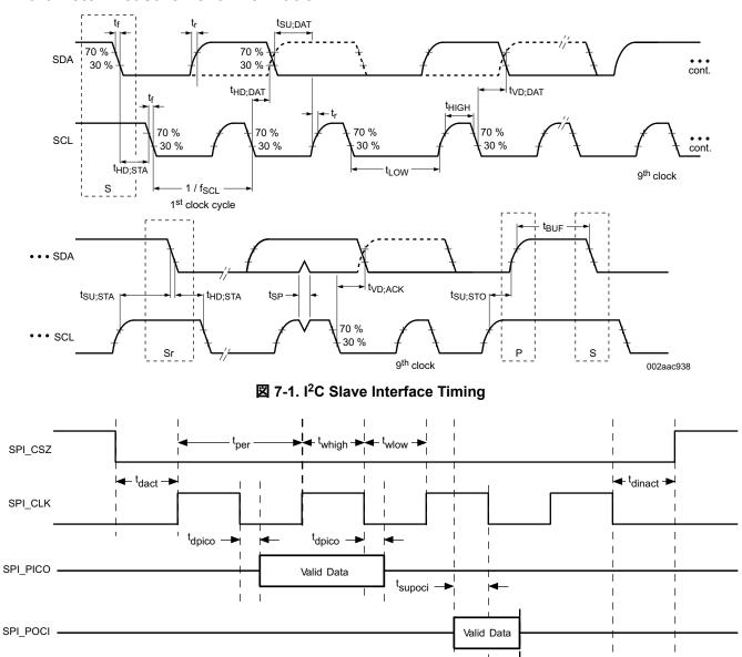
図 7-2. SPI Controller Timing
