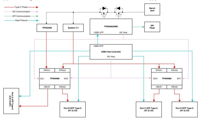
図 9-1. USB4 Device Block Diagram
