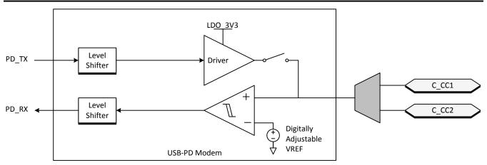
図 8-5. USB-PD BMC TX/Rx Block Diagram
