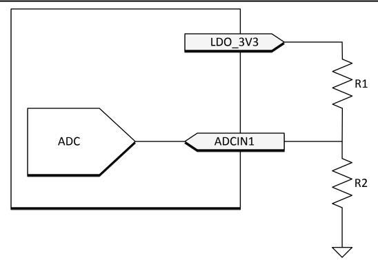
図 8-17. ADCIN1 Resistor Divider
