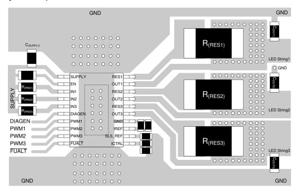
図 10-1. TPS92633 Example Layout Diagram
