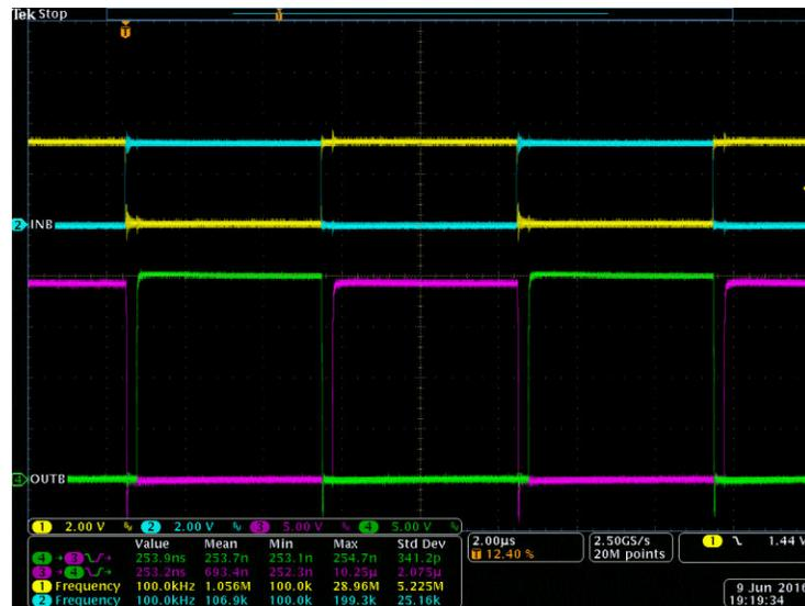
図 8-5. INA/B と OUTA/B のベンチ テスト波形
