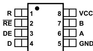
**图 5-1. D Package 8-Pin SOIC Top View**
