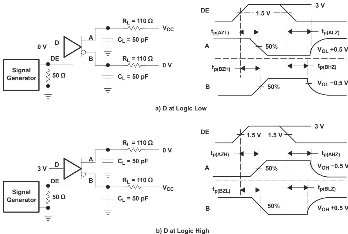
図 7-7. Driver Enable/Disable Test
