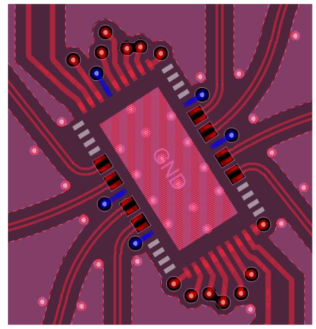
Figure 13. Evaluation Module Layout Using the DS125BR820
