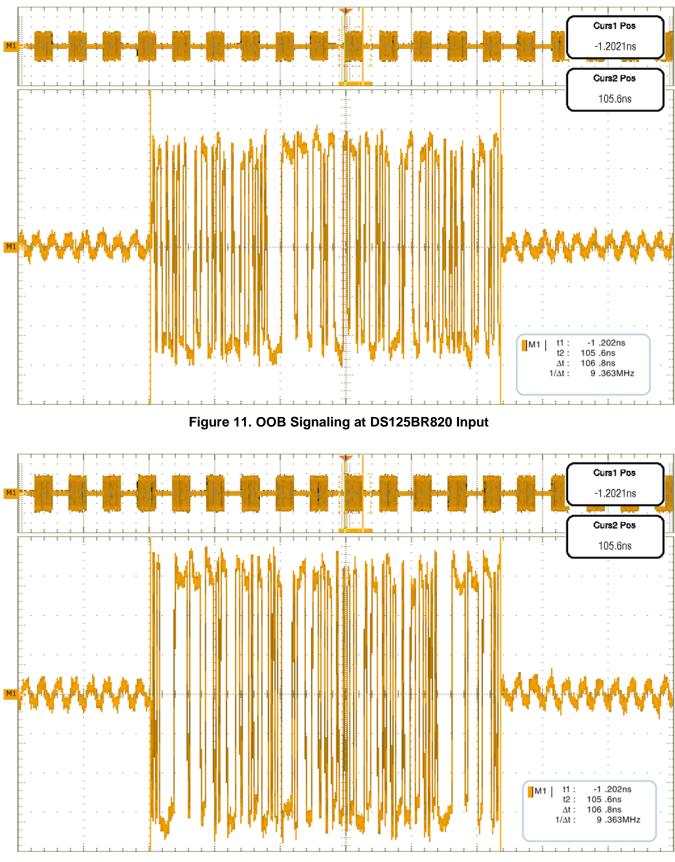
Figure 12. OOB Signaling at DS125BR820 Output
