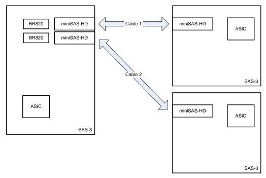
Figure 1. Typical Application Using the DS125BR820
