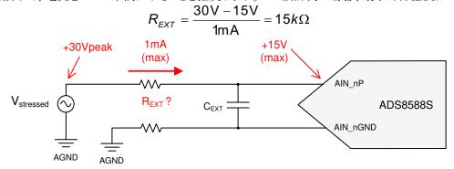
2. 入力フィルタの帯域幅を目的の周波数に設定するために  $R_{ext}$  または  $C_{ext}$  を選択します。アプリケーションによっては、別のカットオフ周波数が必要になります。この場合、50Hz 信号の 128 次高調波を通過させるため、カットオフ周波数を 6.4kHz にする必要があります。この場合、1nF のコンデンサも必要です。1nF は産業用入力フィルタ コンデンサの一般的な容量値です。この式を適用すると、外部抵抗  $(R_{ext})$  の値は 24.9k $\Omega$  と決定されます。この手順で計算される外部抵抗は、手順 1 で求めた最小抵抗値より大きいことに注意します  $(R_{ext} > R_{ext(min)})$ 。
