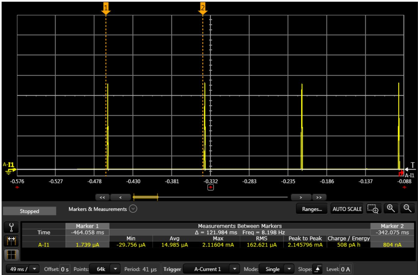
図 9. 単一測定周期、ウェイク・オン・タッチ構成でのTIDM-CAPTIVATE-64-BUTTONの平均消費電力
