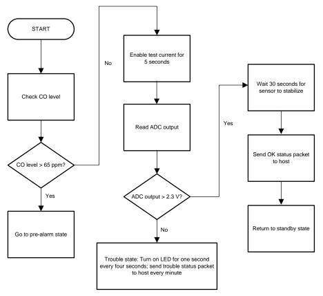
図 14. Sensor Test Procedure
