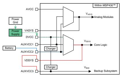
図 3. AUX Module Configuration
