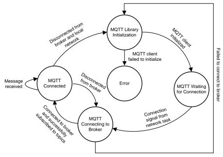
図 8. MQTT Thread Main Loop
