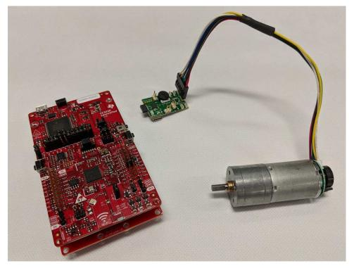
図 15. LaunchPad<sup>™</sup> and BoosterPack<sup>™</sup> Stackup
