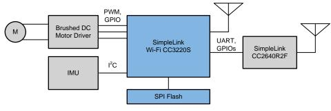
図 1. TIDC-01005 Block Diagram
