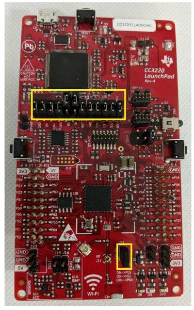
図 11. CC3220S-LAUNCHXL Jumper Configuration
