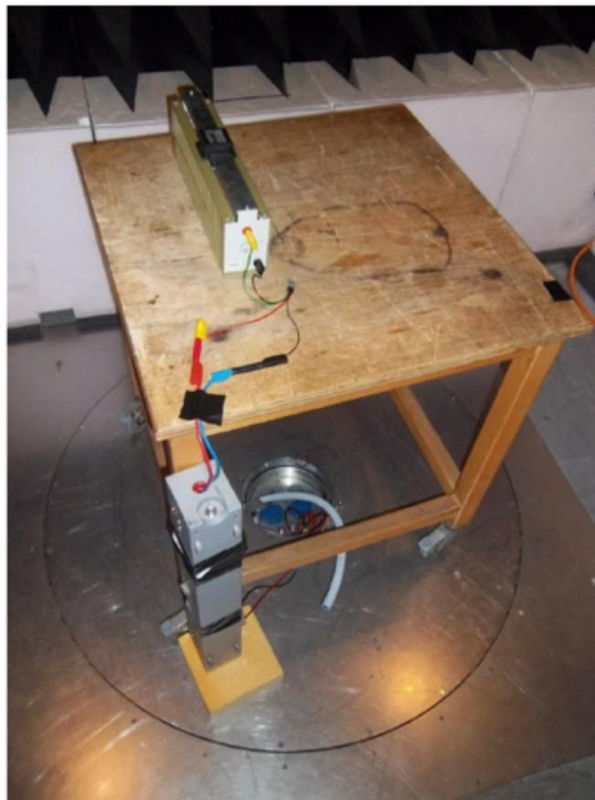
図 26. 放射型電磁波に関する 3m 予備スキャン・テスト構成
