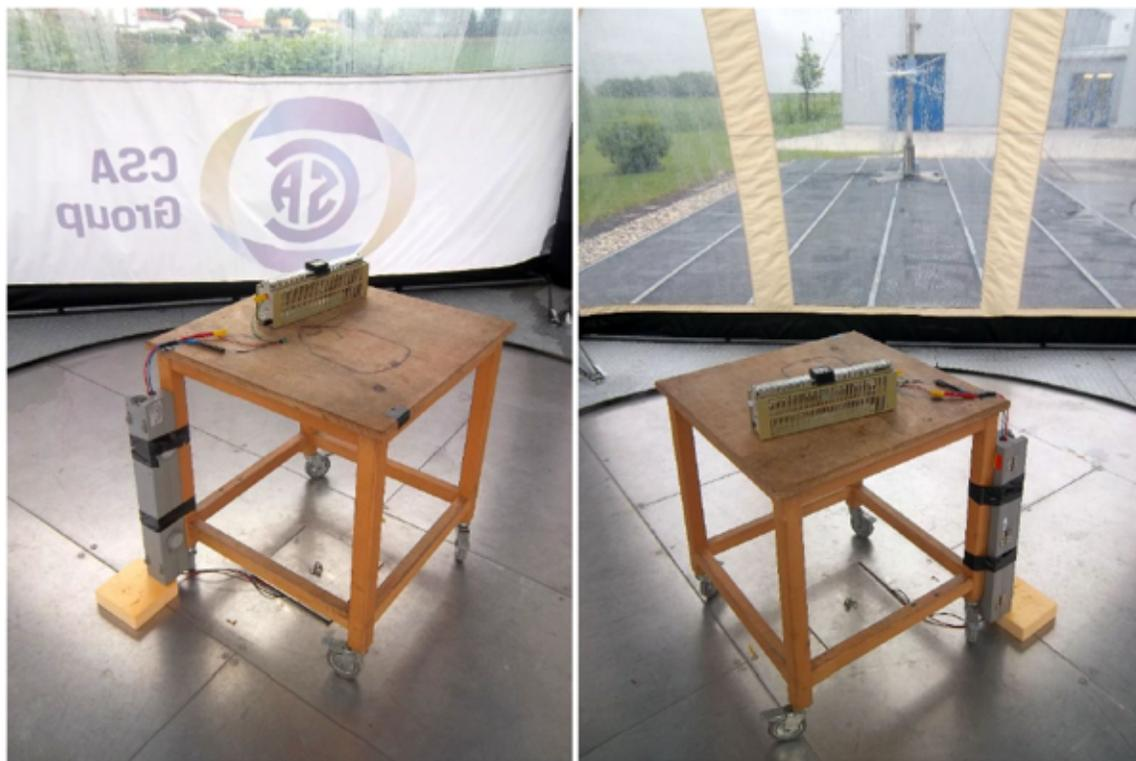
図 29. 放射型電磁波 10m テスト構成
