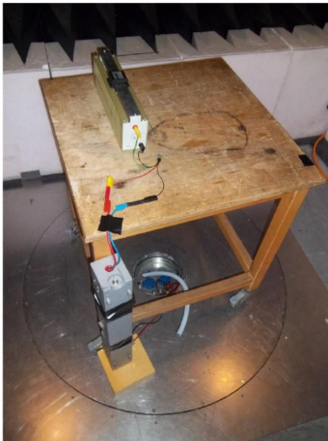
図 26. 放射エミッション 3m 予備スキャン・テスト構成
