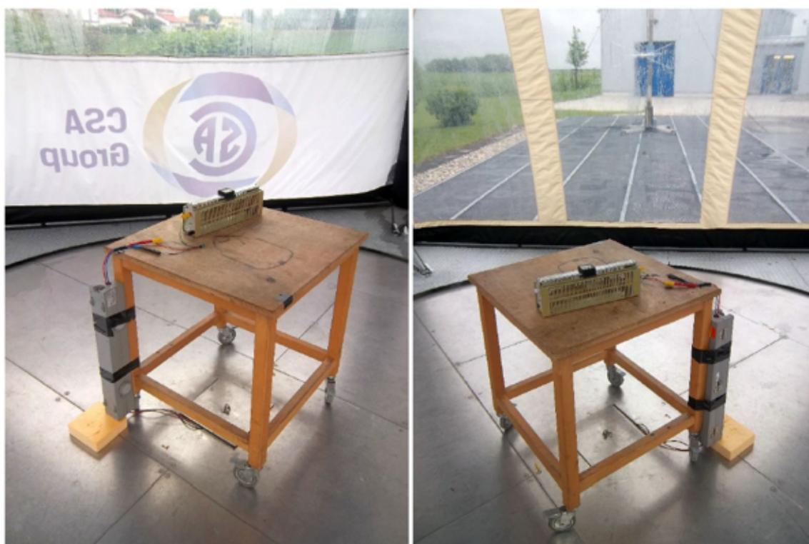
**図 29. 放射エミッション 10m テスト構成**
