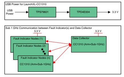
図 1. TIDA-00816 Block Diagram
