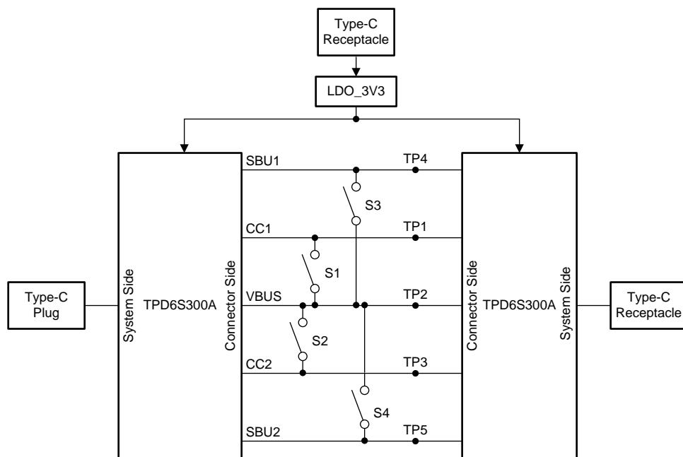
図 1. TIDA-050016 Block Diagram
