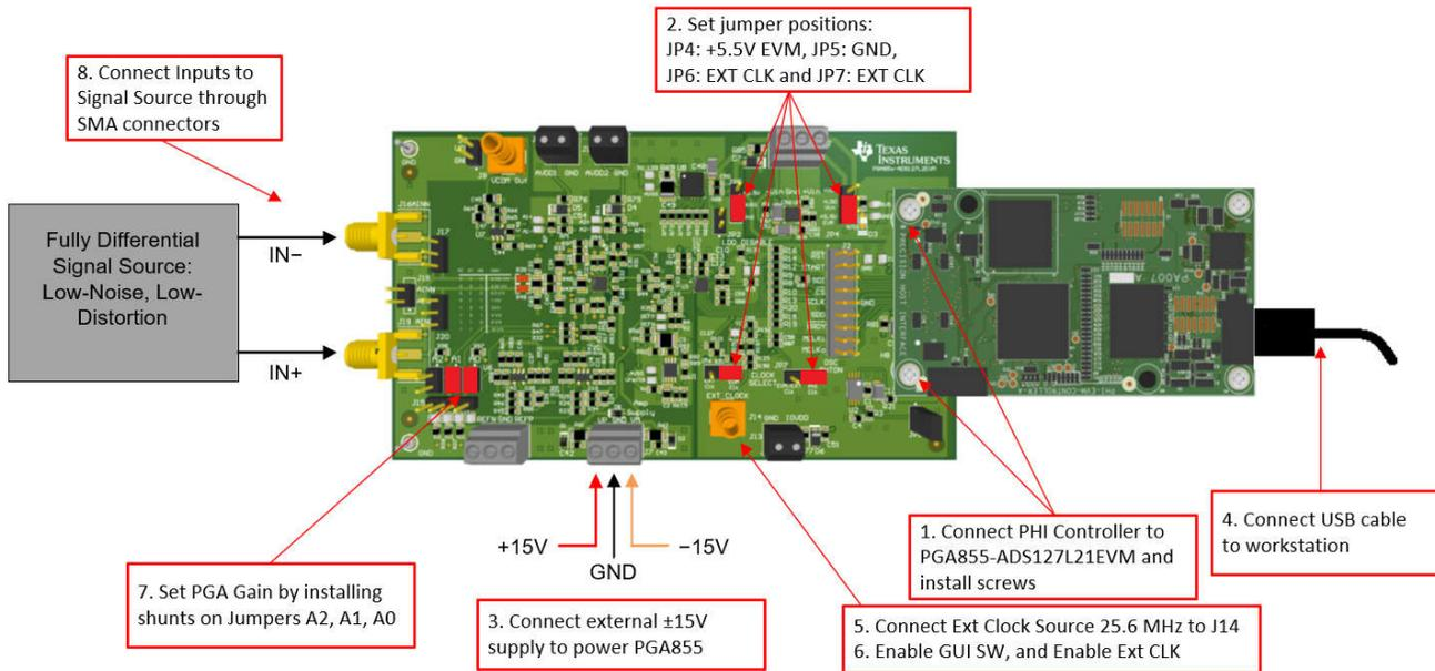
Figure 7-1. PGA855-ADS127L21 Bench Test
