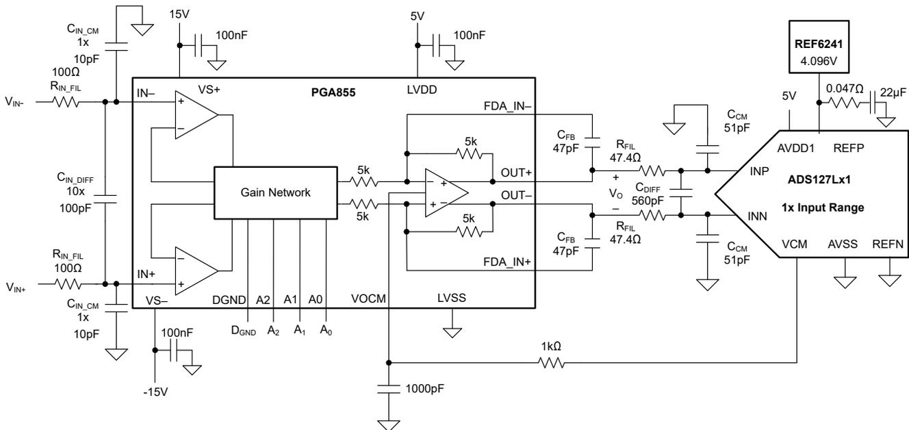
Figure 1-1. PGA855 and ADS127L21, 24-Bit, Delta-Sigma ADC Circuit
