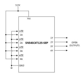
Figure 3-4. SN54SC4T125-SEP SEL Bias Diagram
