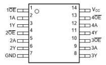
Figure 3-1. SN54SC4T125-SEP Pinout Diagram
