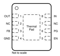
Figure 4-3. Pin Diagram (Adjustable TPS746-Q1 DRB Package)
