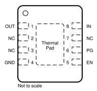
Figure 4-4. Pin Diagram (Fixed TPS746-Q1 DRB Package)
