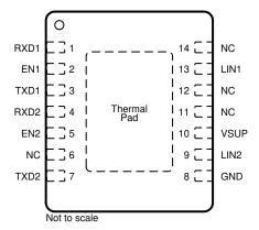
Figure 4-1. DRB Pin Diagram
