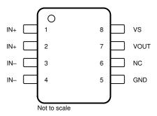
Figure 4-1. TMCS1108-Q1 Pin Diagram
