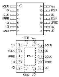
Figure 4-1. Pin Diagram
