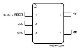
Figure 4-1. Pin Diagram
