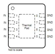
Figure 4-1. Pin Diagram
