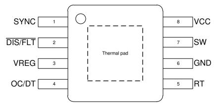
Figure 4-1. Pin Diagram
