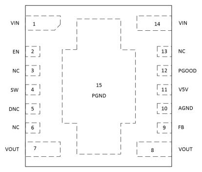
Figure 4-1. Pin Diagram
