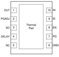
Figure 4-1. Pin Diagram
