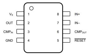
Figure 4-1. Pin Diagram
