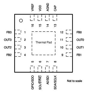
Figure 4-1. Pin Diagram
