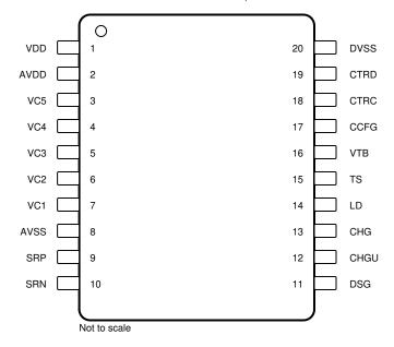
Figure 4-1. Pin Diagram
