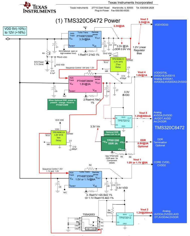
Sequence of Power : 1<sup>st</sup> Vout 3(3.3V) then 2<sup>nd</sup> Vout4 (1.8V), Vout 5 (1.2V) , then 3<sup>rd</sup> Vout 1(1.0/1.1V) , Vout 2(1.2V)
