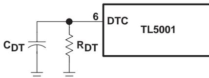
**Figure 2. Soft-Start Circuit**
