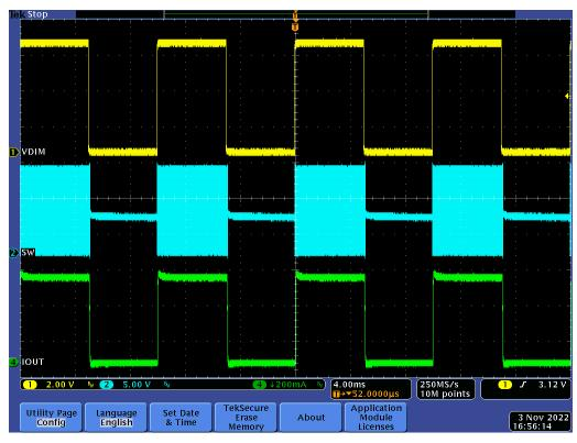
Figure 4-9. 50% Duty Cycle 100-Hz PWM Dimming(TPS92200D1RXLR)
