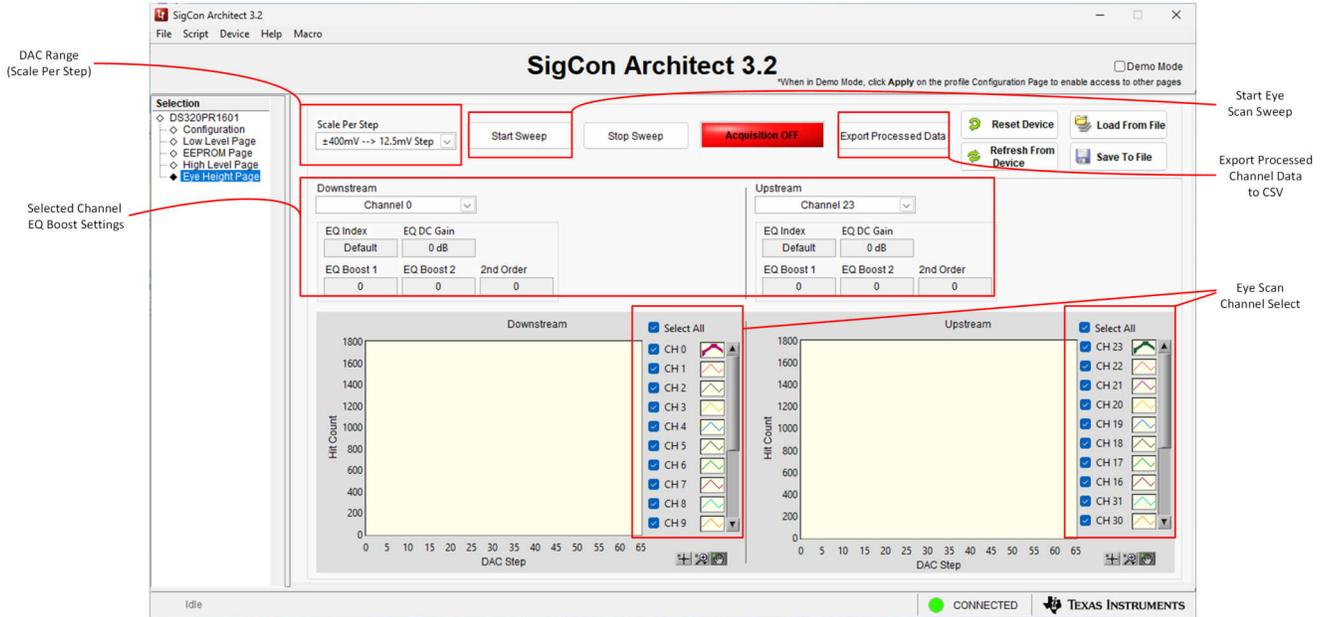
**Figure 5-1. SigCon Architect DS320PR1601 Eye Height Page with annotations**
