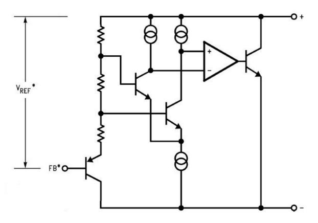
Figure 4. LM4041-N Block Diagram
