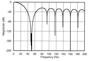
Figure 36. ADS1220 Digital Filter Response
