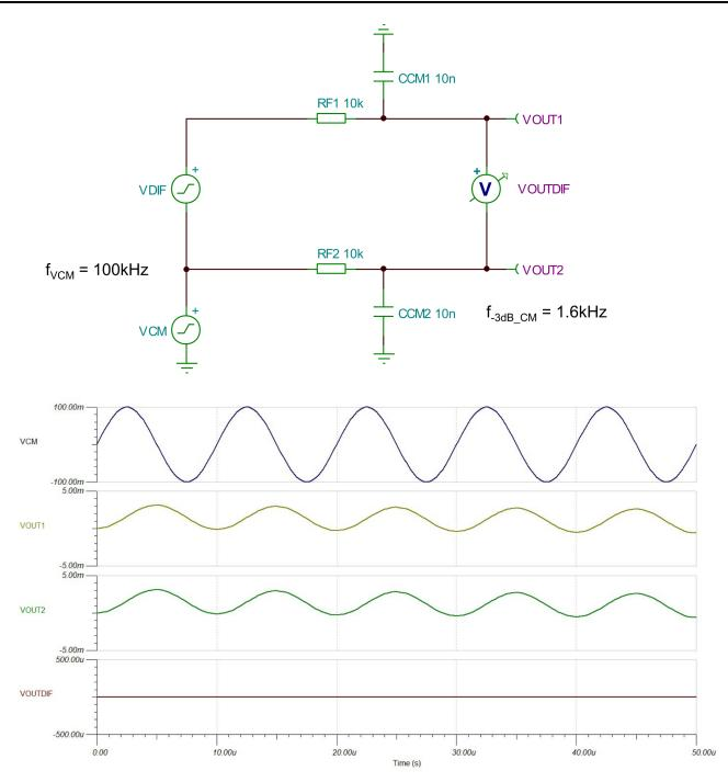
Figure 29. Common-Mode Filter Ideal Matching
