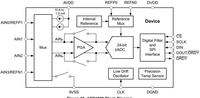
Figure 19. ADS1220 Block Diagram
