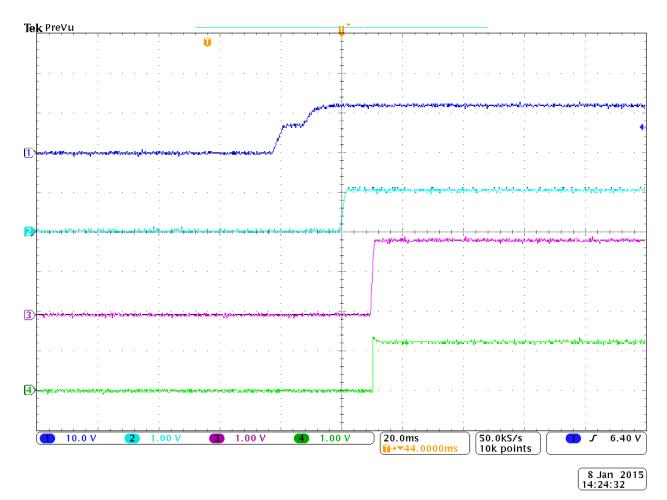
Ch.1: VIN Ch.2: VCCINT Ch.3: VCCAUX Ch.4: VCCO 1.2V
