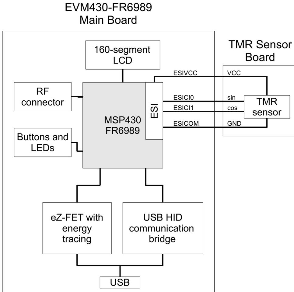
**Figure 3. Block Diagram**
